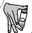
**4. Vorverdünnte Probe in die Küvette pipettieren**
